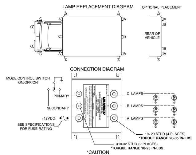
THE STUDS (TERMINALS) ON THE 3860GCP FLASHER ARE SOLDERED TO THE INTERNAL PRINTED CIRCUIT BOARD. OVER TORQUING WILL DAMAGE THE PRINTED CIRCUIT BOARD.
