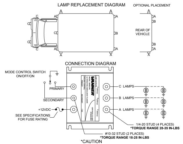
THE STUDS (TERMINALS) ON THE 5860GCPE FLASHER ARE SOLDERED TO THE INTERNAL PRINTED CIRCUIT BOARD. OVER TORQUING WILL DAMAGE THE PRINTED CIRCUIT BOARD.
